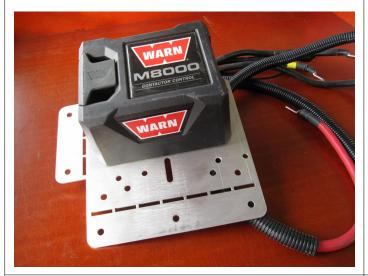
Schaltkasten alte Windenmodelle
