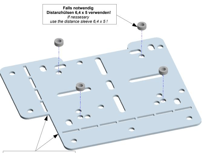
Der Schaltkastenhalter kann an den perforierten Stellen gebogen werden. The holder can be bent at the perforated places.
