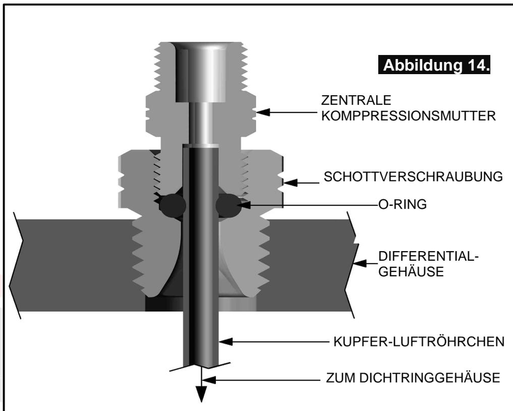
**ANMERKUNG:** Ein übermäßiges Anziehen der zentralen Kompressionsmutter ist zum luftdichten Abdichten nicht notwendig und führt eher zu Beschädigungen am O-Ring, am Luftröhrchen oder am Gewinde der Kompressionsschraube.
