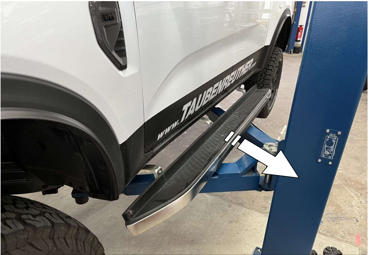
1 Trittbleche entfernen! / Remove the tread plates! Das Gleiche an der rechten Seite! / The same at the right!
