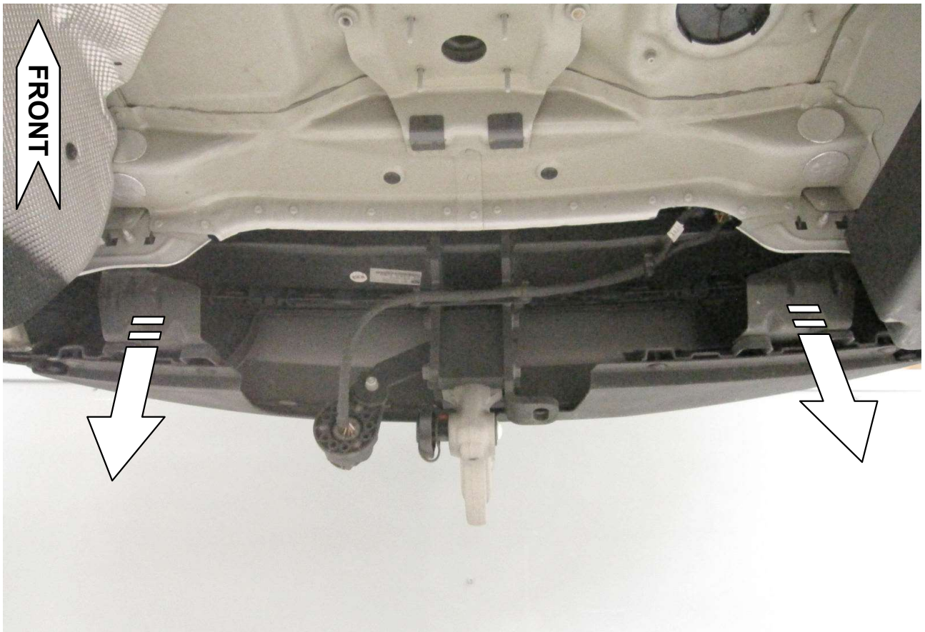
11 Halter ausbauen! / remove bracket !
